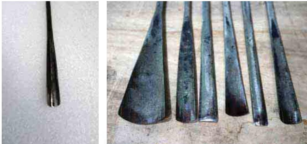
(五) 斜口刀：刀口呈 45°左右的斜角，主要用於作品的關節角落和鏤空狹縫處作剔角修光，如刻人物眼角處需要用斜刀這類木雕工具更為好用。斜刀分為正手斜與反手斜兩種，用於適合木雕上各個方向的需求。雕刻毛髮絲縷通常使用斜口刀，用扼、擰的方法刻出的毛髮效果比三角刀刻得更為生動自然。
