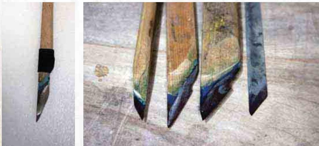
(六) 中鋼刀：俗稱「印刀」，刃口平直兩面都有斜度。中鋼刀這種木雕工具由於鋒口位於正中間，用此工具打坯時可使刀鋒正中落刀，周邊物件不受影響，可明確掌控剔除及保留的物件，亦用於印刻、人物、服飾及道具上的圖案花紋使用。
