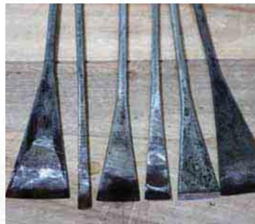
(二) 三角刀：刃口呈三角形，鋒面在左右二側，鋒利點就集中在中角上。製作三角刀要選用適用的工具鋼（一般用4-6毫米的圓鋼），銑出55°至60°的三角槽，將兩腰磨平，其口端磨成刃口，角度大，刻出的線條就粗，反之就細。三角刀主要用於刻毛髮、刻裝飾線紋，也是版畫與水印木刻藝術製版時常用的一種木雕工具，操作時三角刀尖在木板上推進，木屑從三角槽內吐出，三角刀尖推過的部位便刻畫出線條來。
