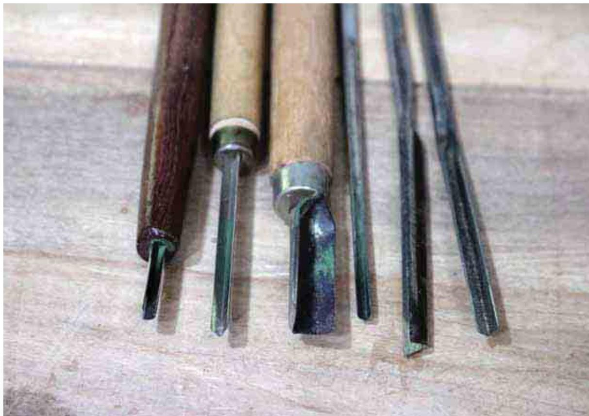
(三) 弧形刀(半圓刀)：也稱玉婉刀、和尚頭、蝴蝶鑿，刃口呈圓弧形，是一種介於圓刀與平刀之間的修光用刀，分圓弧和斜弧二種。在平刀與圓刀無法施展時它們可以代替完成。這種木雕工具的特點是比較緩和，既不像平刀那麼板直，又不像圓刀那麼深凹，適合在凹面起伏上使用。
