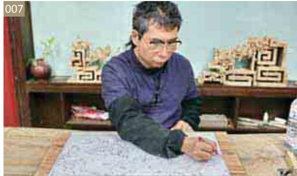
圖稿完成後，以影印機列印三份，第一份貼在木板上，做工作圖稿；第二份做為工作中的參考圖稿；第三份為留用存稿，與描圖紙的原稿一起儲存。圖稿貼在雕刻的樟木板材上，以紅筆圈點鑽孔的位置，線鋸切割前，必須再次確認無誤後方可進行鑽孔作業。
