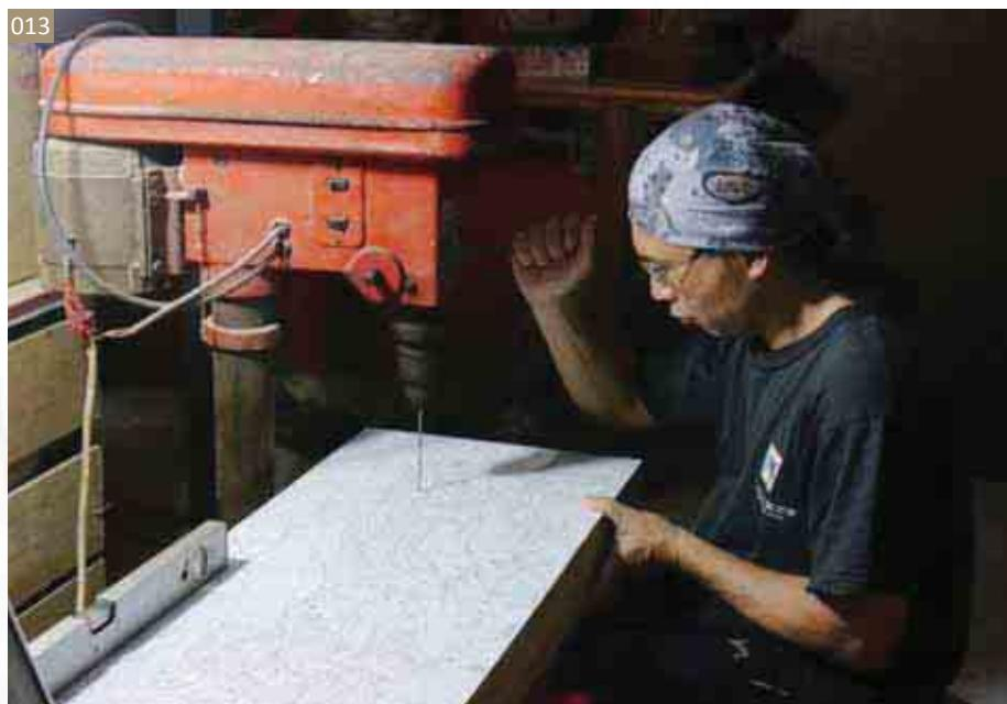
▲藉由電鑽工具，將欲穿透鏤空之處，進行鑽孔。
