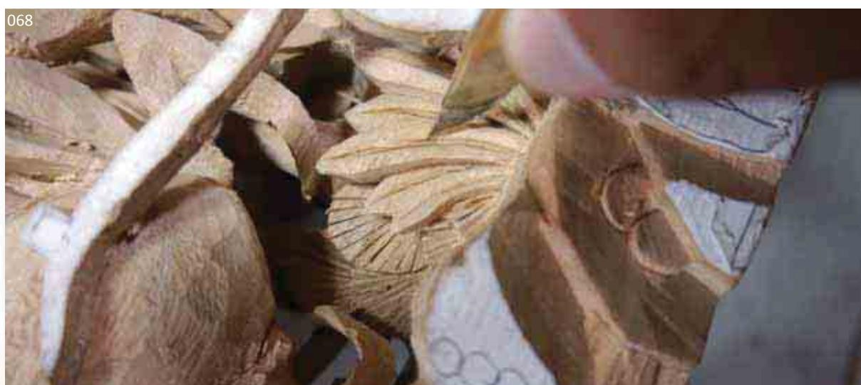
▲以三角刀切割植物葉脈的施作方式，平行雙線，末端交接成尖形，外至內刻。
