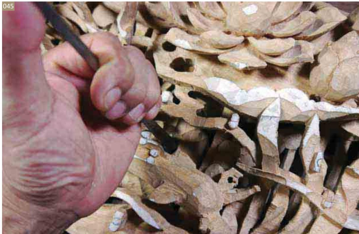
▲細修時，必須將線鋸切割過的鋸搓痕跡修除乾淨，只能留下雕刻刀的刀痕。深層的細修，也可以同時完成線刻的工作，同時完成線刻，可以避免周邊物件二度碰撞。
