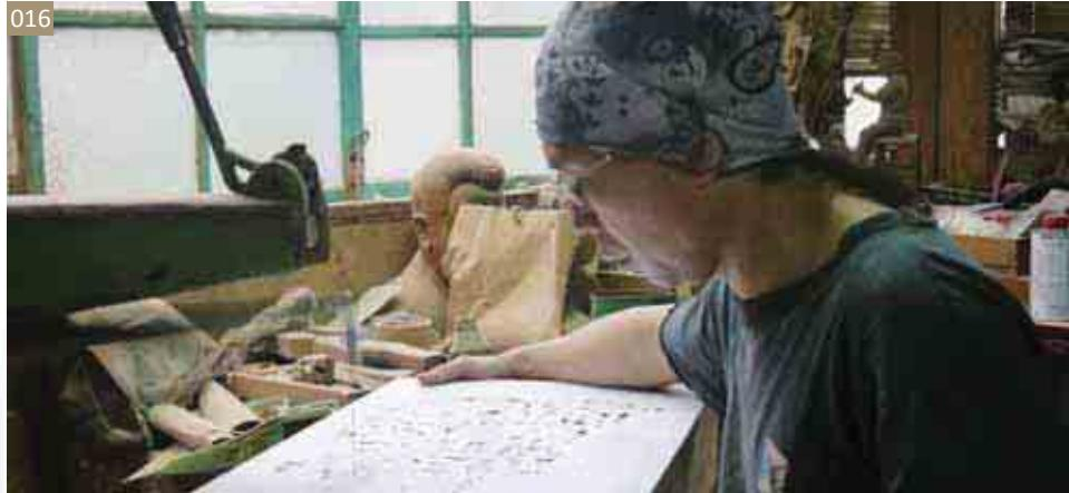
▲以線鋸為工具，將線鋸條穿過鑽洞孔，仔細切割穿透範圍。
